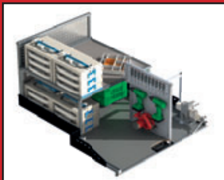
Mitteltrennwand hoch mit Stütze auf Plateau / middle partition wall high with extension on the sliding tray
